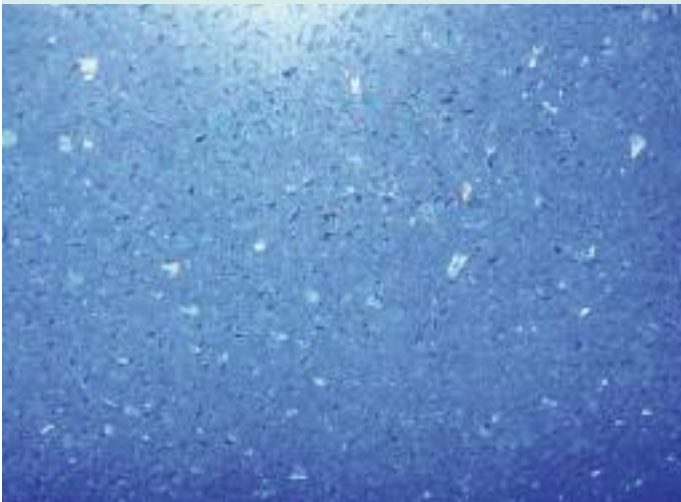
Manchmal kann man nur an der ungewöhnlichen Farbe erkennen, dass es sich um Kompositstein handelt. Bilder: Uwe Büttner
