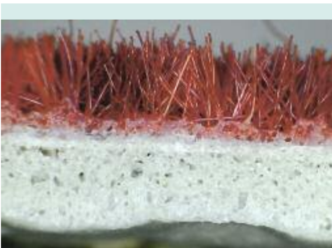
Beflockter Textilbelag: Der Aufbau – eine wasserdichte Trägerschicht aus Vinyl und eine stabilisierende Glasfasermatte, auf der die Fasern senkrecht aufgeklebt werden – macht den Bodenbelag extrem widerstandsfähig.
