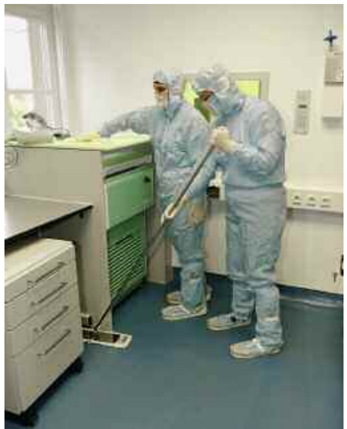
Ein Reinraum nach GMP – hier zur Herstellung von Zytostatika – wird grundsätzlich desinfizierend gereinigt.
